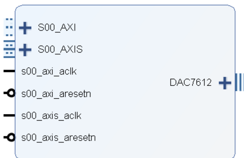
图 3-8 开发套件 DAC 接口 IP
