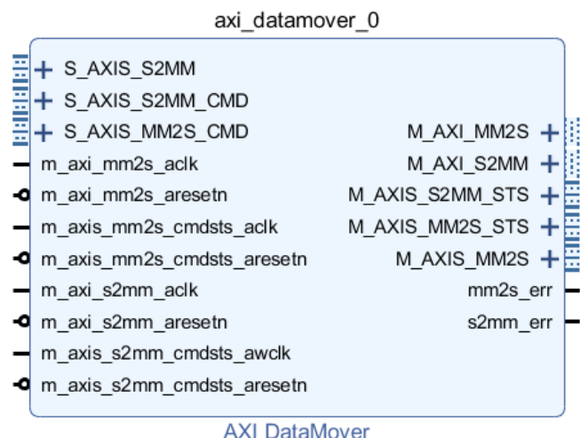
图 4-9 S2MM 和 MM2S 全部使能
