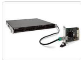
Rack-mount 控制器通过 MXI-Express 或 MXI-4 可连接 PXI 或 PXI Express 机箱
