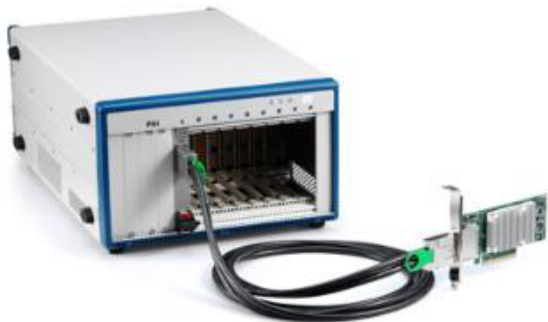
采用双端口 MXI-Express 的远程控制可以同时控制两个 PXI 机箱，总吞吐率为 528MB/s
