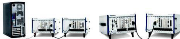
采用 MXI-4 的远程控制，可以实现通过 PC 机控制 PXI 以及多机箱的 PXI 系统
