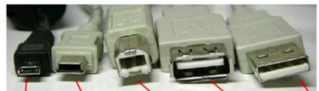
mini USB(A型)、mini USB (B型)、USB (B型)、USB (A型)、USB (A型)
