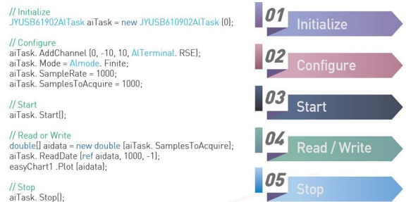
基于锐视驱动的有限点数据采集流程
