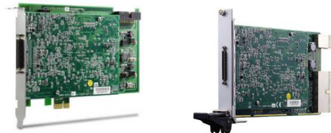
两种不同的封装使用同一软件标准。 就软件而言，对 PXI 模块 (下方) 的编程和对 PCI 板卡 (上方) 的编程是一样的
